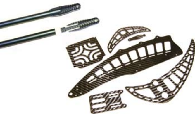
Die aus CFK/GFK-Verbundmaterial gefrästen Platten sind von exzellenter Qualität. Die Kanten sollten vor dem Verbau mit Schleifsteinen gebrochen werden
