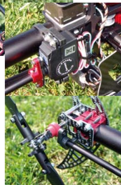
Auch der Heckrotor ist vom Feinsten. Die Drehstabanlenkung weiß mit Leichtgängigkeit und Spielfreiheit zu überzeugen. Man beachte die Momentausgleichsgewichte an den Metallblatthaltern
