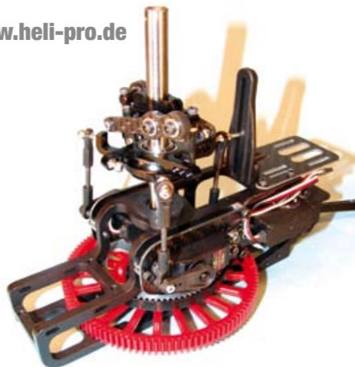
Das mit den Taumelscheibenservos komplettierte Chassis. Das Hauptzahnrad mit 106 Zähnen, Modul 1, ist aus Kunststoff spritzgegossen und läuft sehr gut rund. Der Freilauf besitzt beidseitig Kugellager zur Führung der Welle. Gut zu sehen: Die senkrecht nach oben verlaufenden Anlenkgestänge zur Taumelscheibe. Letztere bietet an Innen- und Außenring unterschiedliche Einschraubmöglichkeiten für die Kugelköpfe
