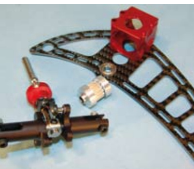
Die Teile des Heckrotors genügen allerhöchsten Qualitätsansprüchen und sind durchweg in Carbon oder Aluminium gefertigt
